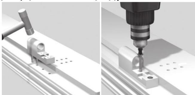
**3. Установить в рамную часть петли втулку с осевым штифтом, исходя из наплава створки (см. инструкция по наплаву).**
