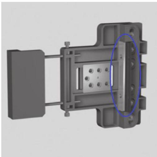
Используя регулировки, описанные выше, настраиваем кондуктор исходя из предустановки петли, ширины створки, высоты наплата, а также желаемого места крепления петли в раму.
