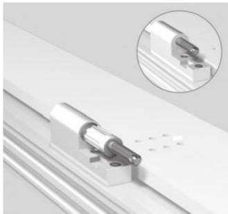
**4. Отрегулировать втулку створочной части петли, исходя из наплава створки (см. инструкция по наплаву).**
