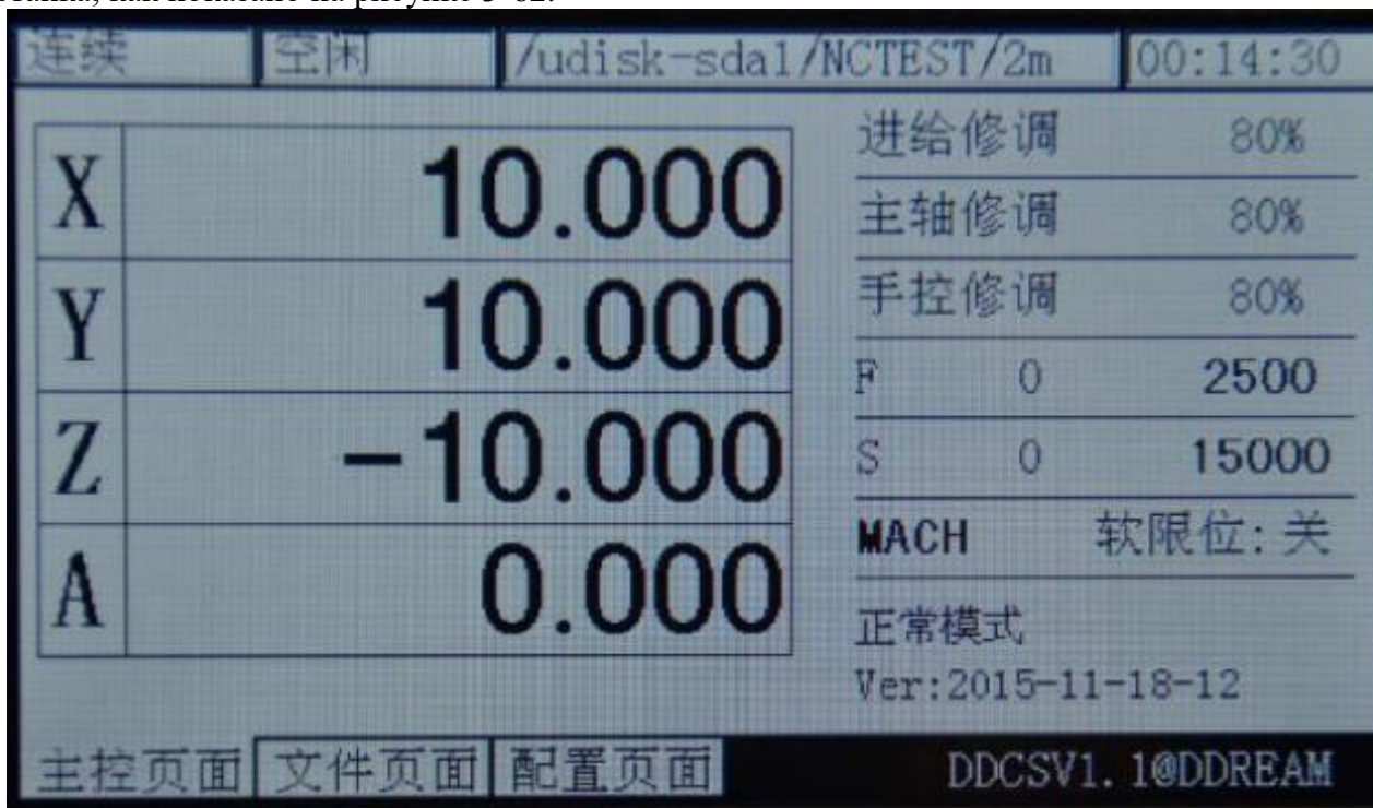
Рисунок 3-62. Переключение на систему координат станка
