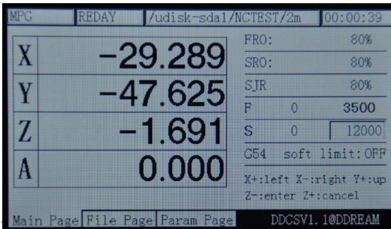
Рисунок 3-44. Установление значения S равным 12000
