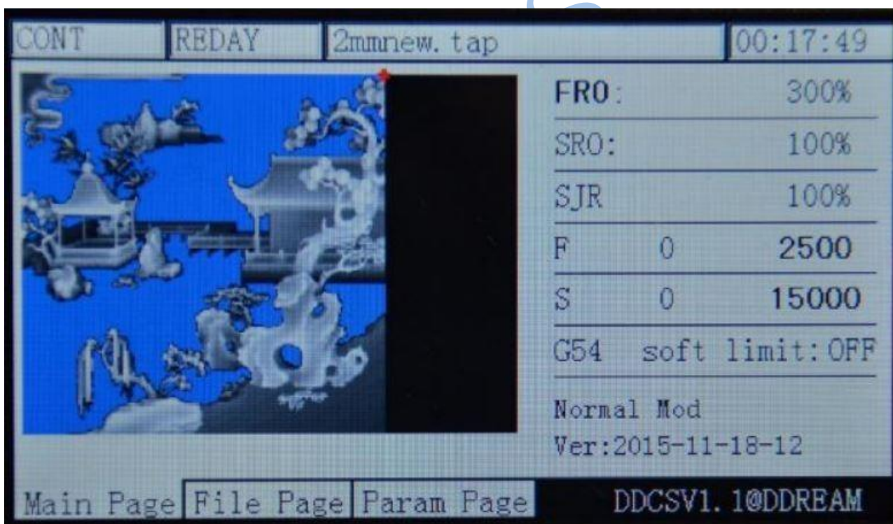
Рисунок 3-16. Состояние управляющей траектории при завершении процесса
