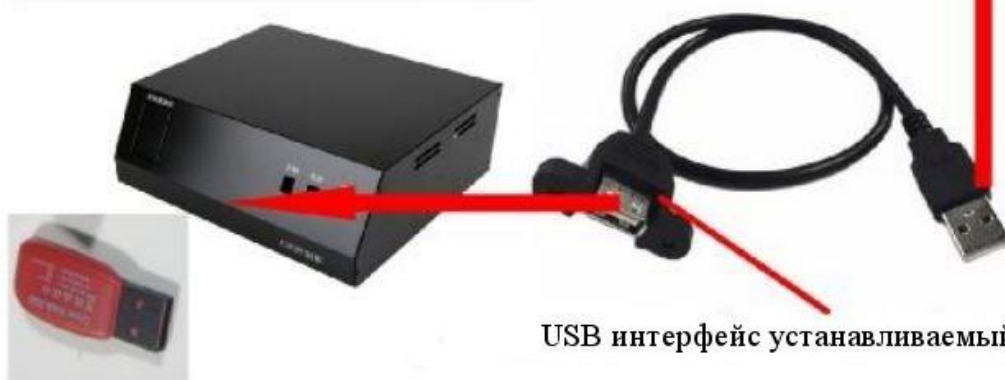
Рисунок 2-4 Схема подключения USB интерфейса
