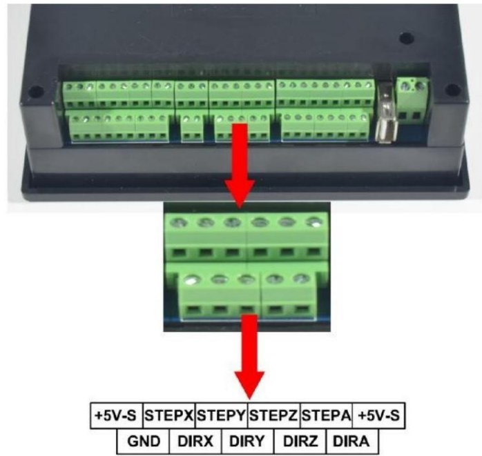
Рисунок 2-7. Интерфейс подключения двигателей
