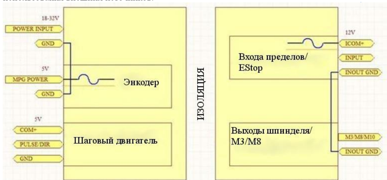
Рисунок 2-1. Подключение источников питания
