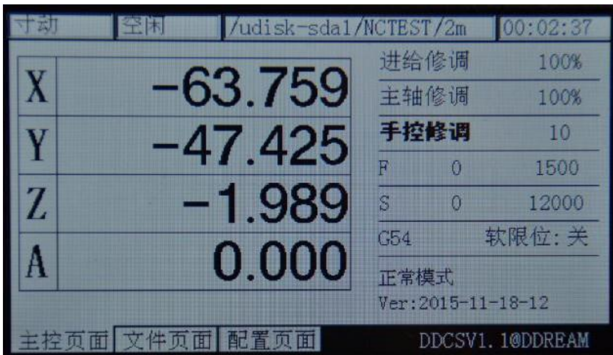
Рисунок 3-35. Применение SJR с установленным значением, равным 10
