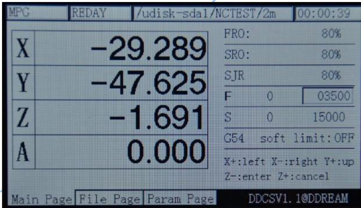
Рисунок 3-39. Использование кнопок X+, X-, Y+, Y- для установления значения F=3500
