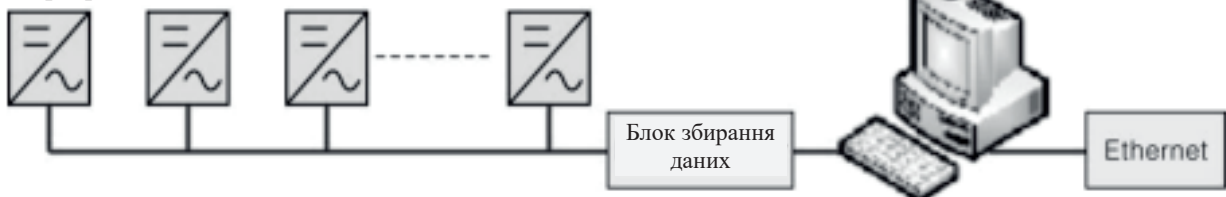
Рисунок 10 – Блок збирання даних і ПК здійснюють моніторинг через інтерфейс RS485
