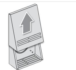
4. Зафиксируйте тыльную часть вентиляционного колпака на стене шурупами 4х40 из комплекта поставки.
