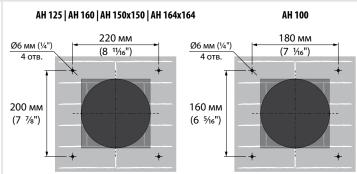
3. Установите дюбели 6х40 из комплекта поставки в отверстия. Разберите наружный вентиляционный колпак для обеспечения доступа к крепежным отверстиям. Снимите фронтальную часть наружного вентиляционного колпака.
