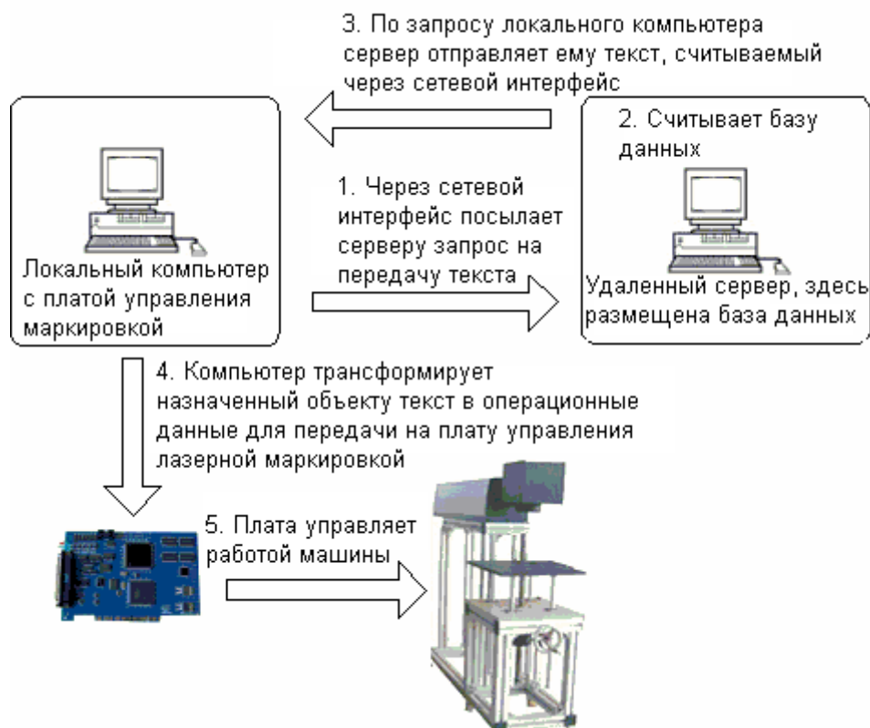
Рис. 4-42. Блок-схема коммуникации TCP/IP.
