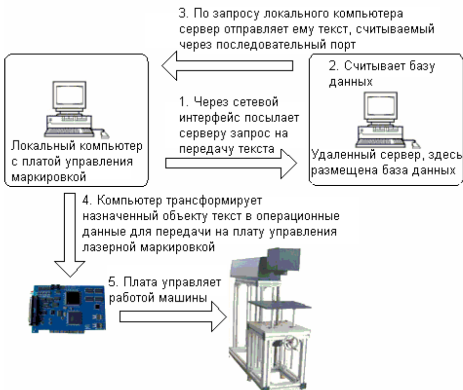
Рис. 4-44. Блок-схема последовательной передачи данных
