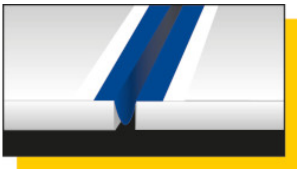
Укладання Mapeband у деформаційний шов у формі літери Ω
