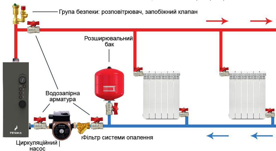
Мал.2. Рекомендована принципова схема опалення
