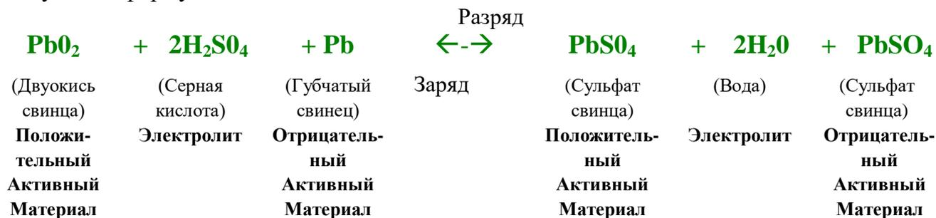
При разрядке диоксид свинца в положительных пластинах и губчатый свинец в отрицательных пластинах реагируют с серной кислотой в электролите и постепенно преобразуются в сульфат свинца; в течение этого процесса концентрация серной кислоты уменьшается.
