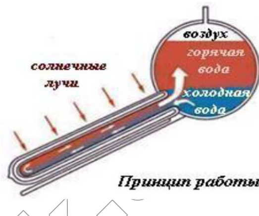
Рис. 1. Принцип нагрева воды и строение вакуумной трубки
