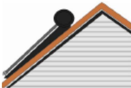
Гелиоприёмник, установленный на наклонной кровле.
