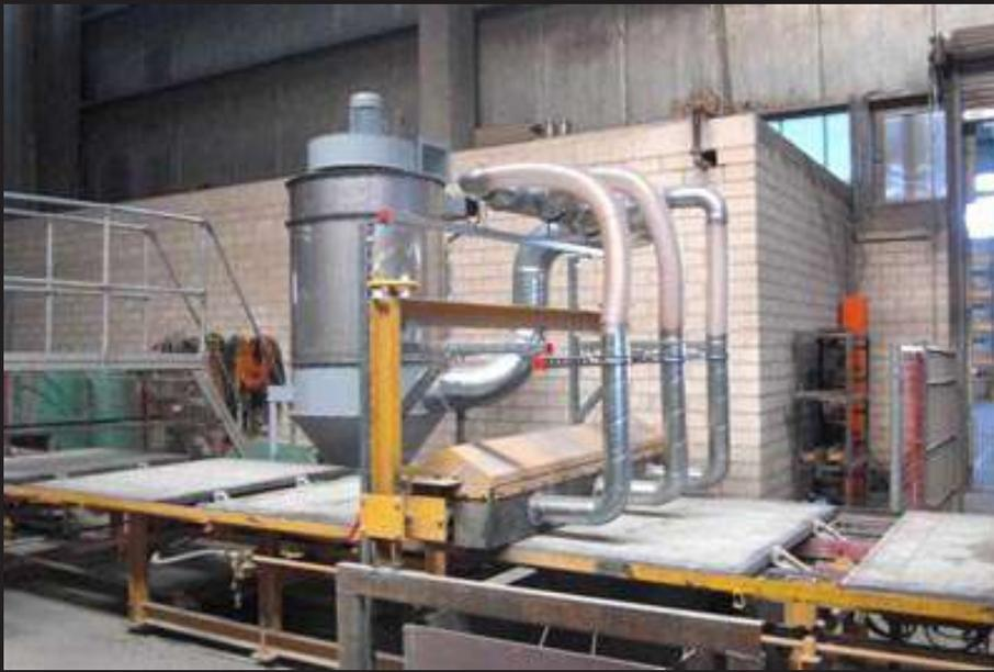
Установки пылеудаления с струйной очисткой фильтра сжатым воздухом (шлифовальная пыль, металлическая и пластиковая стружка), и переносимая по воздуху пыль ( в точках фасовки и передачи материала). Класс пыли М (EN 60335-2-69)
