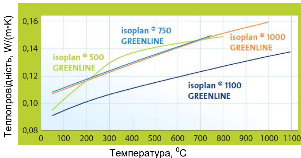
Графік залежності коефіцієнта теплопровідності від температури.
