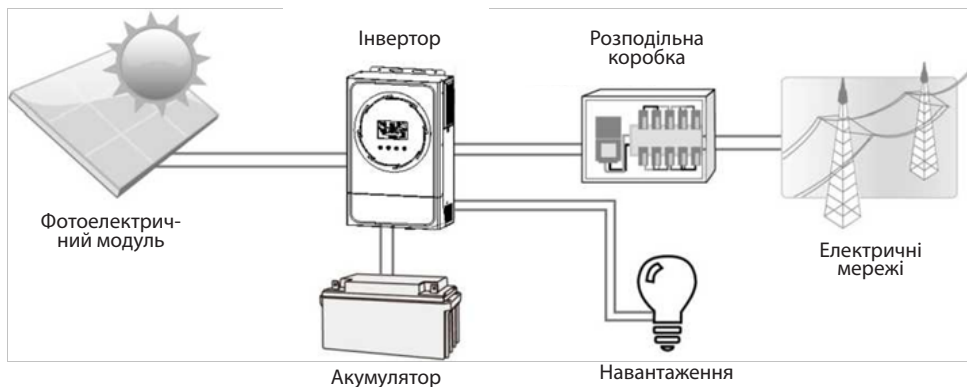
Малюнок 1 Загальний огляд фотоелектричної системи
