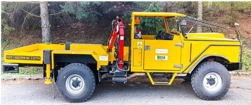
Одностреловый компактный кран-манипулятор HDS, устанавливаемый на легкие грузовики и самые маленькие грузовики большой грузоподъемности. Кран построен на базе комплектующих высшего класса, в том числе пропорциональных распределителей и армированных гидравлических шлангов, поставляемых ведущими европейскими и американскими производителями.
