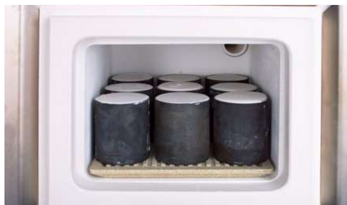
Универсальность: 9 опок 3-го размера, 4 опоки 6-го размера, 3 опоки 9-го размера
