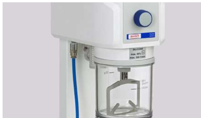
Чрезвычайно быстрое создание вакуума благодаря подключению сжатого воздуха
