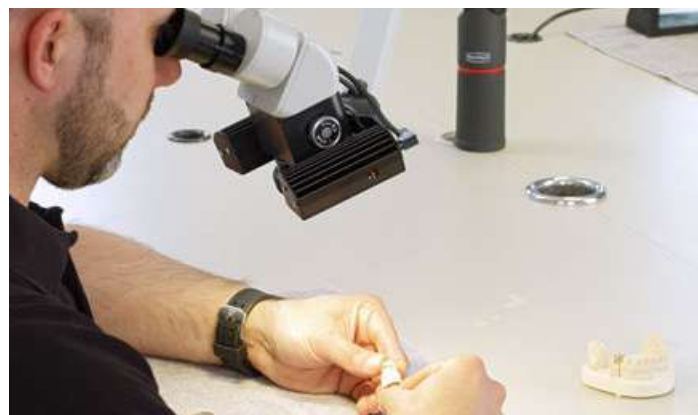
Высокая резкость по краям благодаря асферическим линзам
