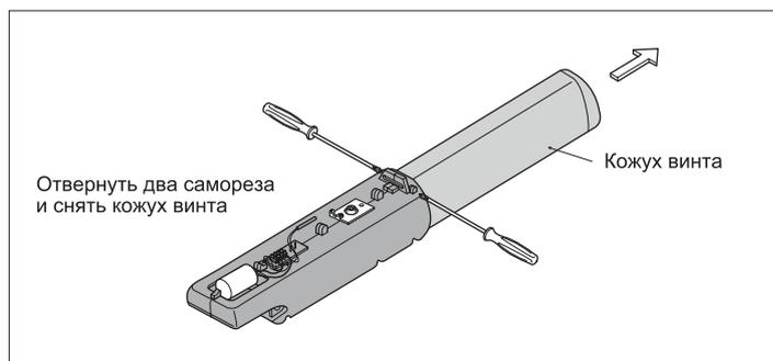
2. Отверните два самореза и снимите кожух винта
