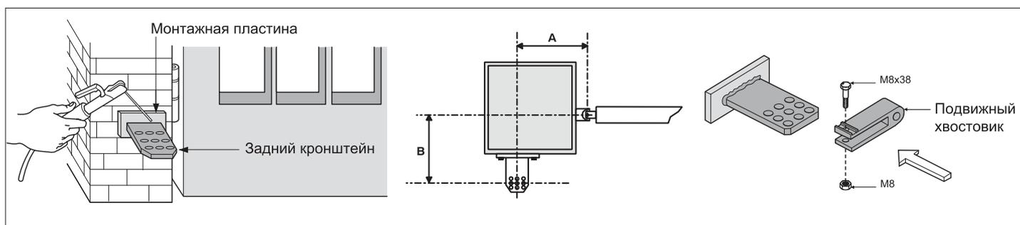
1. Закрепите задний кронштейн с соответствующей крепежной пластиной на столбе, как показано на рисунке выше, соблюдая размеры А и В, а именно расстояние между осями центрального отверстия кронштейна и стержня петли ворот. Задний кронштейн имеет несколько отверстий, которые облегчают установку привода, а также дают возможность изменять угол открытия ворот. В зависимости от положения петель ворот можно удлинить или укоротить задний кронштейн.
