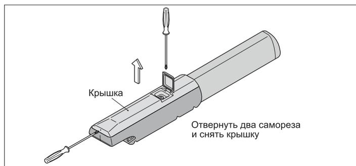
1. Отверните два самореза и снимите крышку
