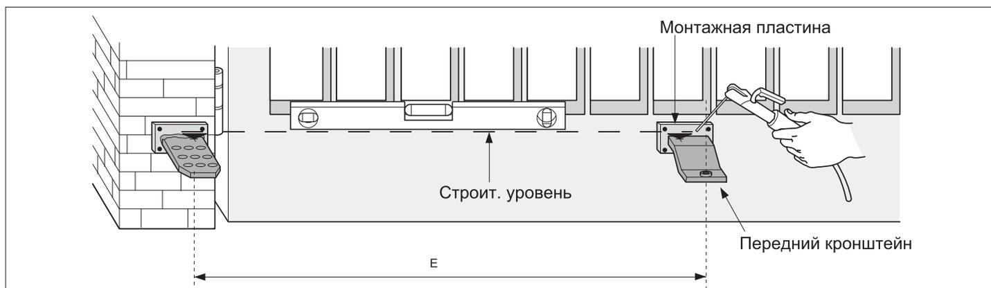
3. При закрытых воротах установите монтажную пластину на створку ворот. Убедитесь, что передний кронштейн установлен горизонтально на одном уровне с задним и выдержан размер D (см. стр. 8).
