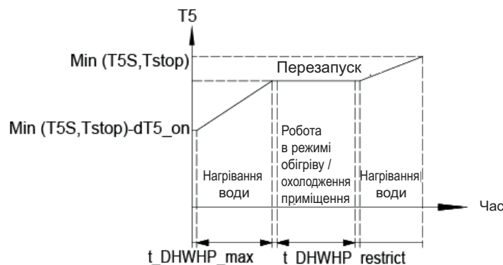
Рисунок 3-8.9: Работа в режиме DHW PRIORITY
