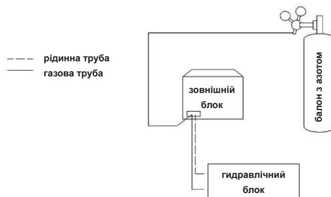
Рисунок 3-3.9: Промивка труб азотом
