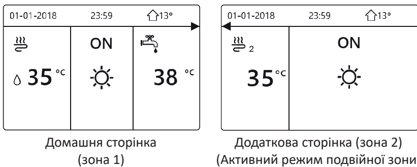
Рисунок 3-8.22: Для параметрів WATER FLOW TEMP. і ROOM TEMP. встановлено значення YES, для параметра DOUBLE ZONE встановлено значення NON або YES
