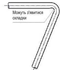
Рисунок 3-3.4: Згинання труби більш ніж на 90^\circ
