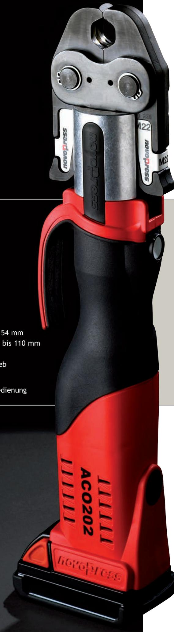
Das Gerät verfügt über eine automatische Ablaufsteuerung, d.h. ab Beginn des Kraftaufbaus läuft die Verpressung vollautomatisch ab, selbstverständlich inkl. Rücklauf. Am Ende einer erfolgreichen Verpressung wird der Motor automatisch abgeschaltet. Ein Handentriegelungsventil gewährleistet ein hohes Maß an Anwendersicherheit durch jederzeit mögliche Unterbrechung des Pressvorgangs.
