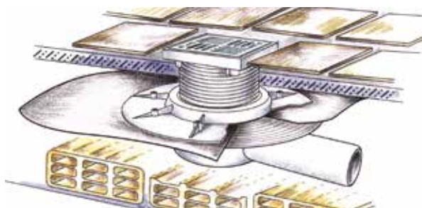
esempio di installazione con membrana impermeabilizzante
