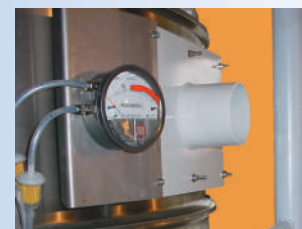
Индикатор давления измеряет сопротивление фильтра
