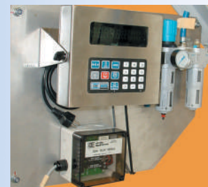
Электронные весы контролируют вес заполняемого мешка BigBag
