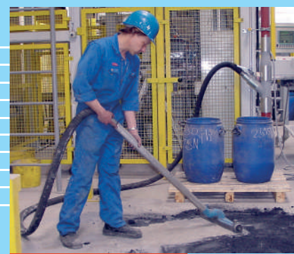
Производство сухих строительных смесей, централизованная пылеуборка в цеху фасовки добавок
