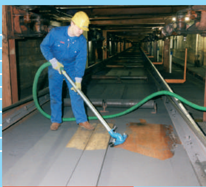
Завод металлопроката, уборка роликового транспортера
