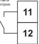
Зовнішнє підключення | Сухий контакт сигналізації стану вимикача резервної лінії живлення.<br>Замкнений, коли вимикач резервної лінії живлення включений.                                                                                                                                                                                                  |
