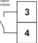
Зовнішнє підключення   | Сухий контакт сигналізації стану вимикача основної лінії живлення.<br>Замкнений, коли вимикач основної лінії живлення включений.                                                                                                                                                                                                    |
