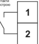
Зовнішнє підключення   | У випадку, коли живлення основного вводу зникає (або виходить за межі уставок), а живлення на резервному вводі - відсутнє, контакти 1-2 замикаються та дають команду на запуск генератору. Контакт залишається замкнутим доки не відновиться напруга на основному вводі, після чого відбудеться повернення та контакт розімкнеться. |
