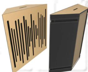
Vicoustic Super Bass Extreme Ultra є досить ефективною басовою пасткою, яка задіює три різні технології. Підходить для установки в кутах, забезпечує ефективне поглинання низьких частот в діапазоні 60-125 Гц з максимальною ефективністю в діапазоні 75-100 Гц. Дерев'яна передня панель виконує дві функції: забезпечує достатнє поглинання середніх і високих частот для управління відбиттям звукових хвиль в кутах, що не переглушує звук, і одночасно діє як дифузор.
