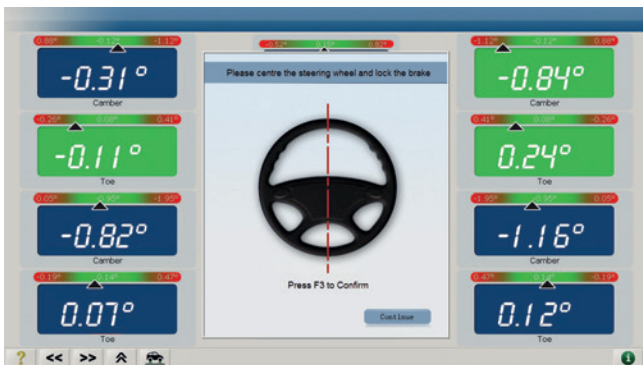
Abb. 52: Центрирование рулевого колеса и блокировка тормоза
