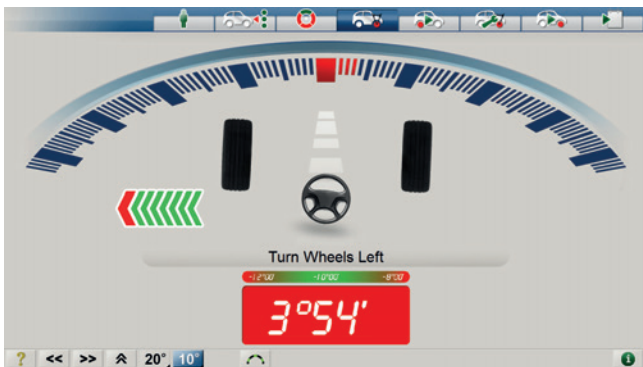
Abb. 40: Среднее положение рулевого колеса
