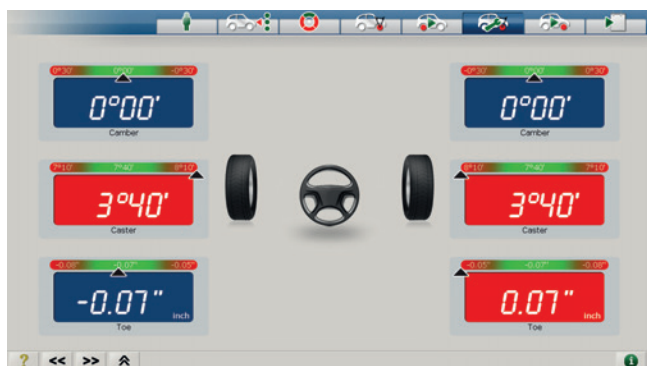
Abb. 47: Измерение продольного наклона
