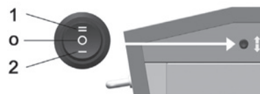
Abb. 20: Кнопочный выключатель для регулировки высоты
