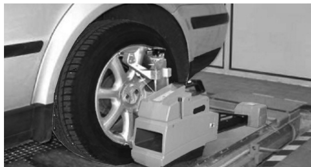
Рис. 12: Позиционирование задних измерительных датчиков
