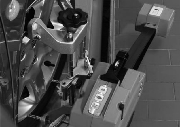
Рис. 13: Выравнивание положения измерительных датчиков
