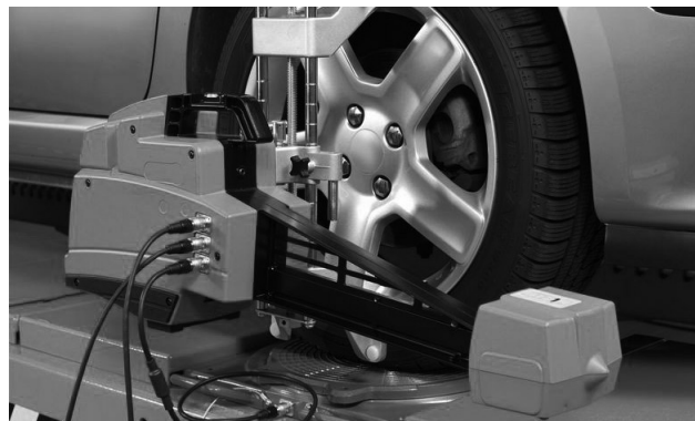
Рис. 11: Позиционирование передних измерительных датчиков
