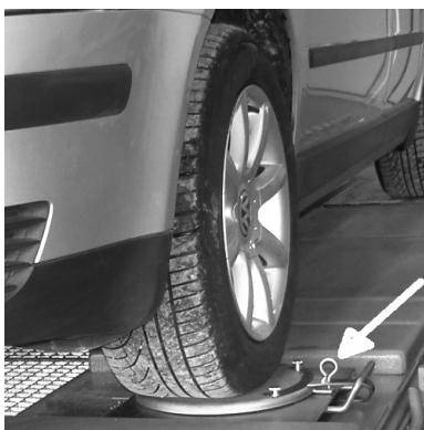
Рис. 7: Поворотная опора с фиксатором
