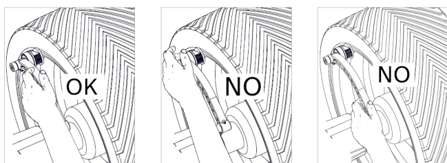
Рис. 28: Правильное обращение с электронным раздвижным калибром
