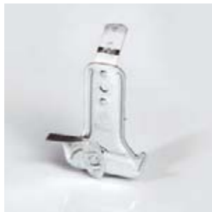
Подвес для быстрого монтажа Ankerfix CD 60/27 С блокировкой поворотным рычагом для фиксации в профиле, крепится при помощи тяги с петлей
