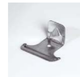
Анкерный уголок для профиля CD 60/27 Для крестообразного соединения профилей CD под углом 90°
