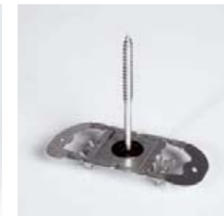
Регулируемый зажим для CD 60/27 Включая винт Torx для регулируемого непосредственного крепления к деревянной конструкции
