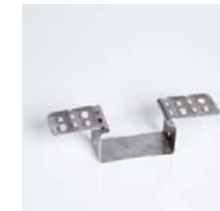
Крепежный зажим для CD 60/27 Для непосредственного крепления к деревянным балкам. Возможно выравнивание высоты до 27 мм
