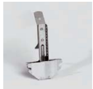
Комбинированный подвес для CD 60/27 Крепится при помощи тяги с петлей или нониус-системы. Надежно фиксируется в профиле благодаря двойному зажиму
