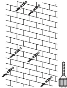
1. Прикрепите вытяжку задней поверхностью к стене при помощи саморезов с дюбелями из монтажного комплекта.
