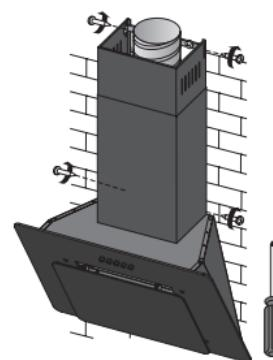
2. Установите адаптер воздуховода на вытяжку при помощи саморезов с использованием уплотнителя из монтажного комплекта.
