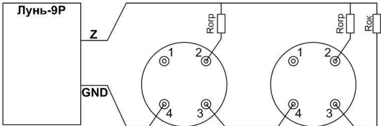
Рисунок 10. Подключение извещателей в пожарный шлейф
