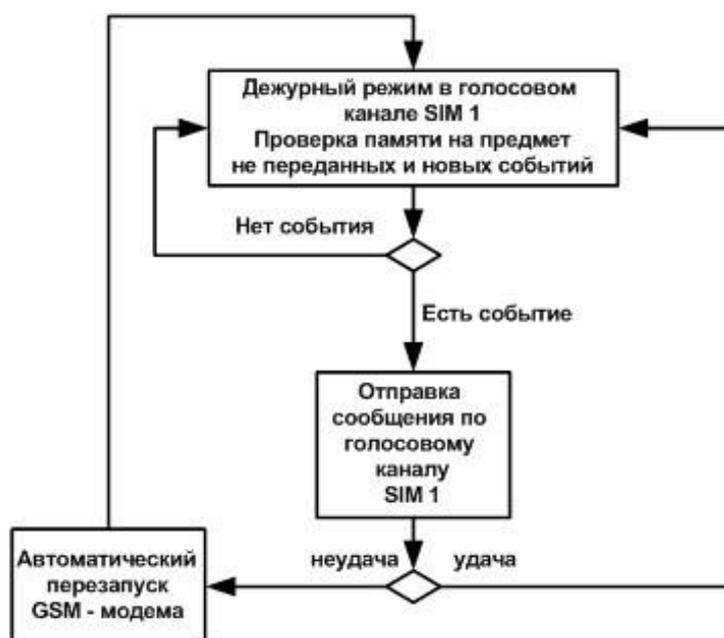
Рисунок 6. Использование голосового канала связи для одной SIM-карты
