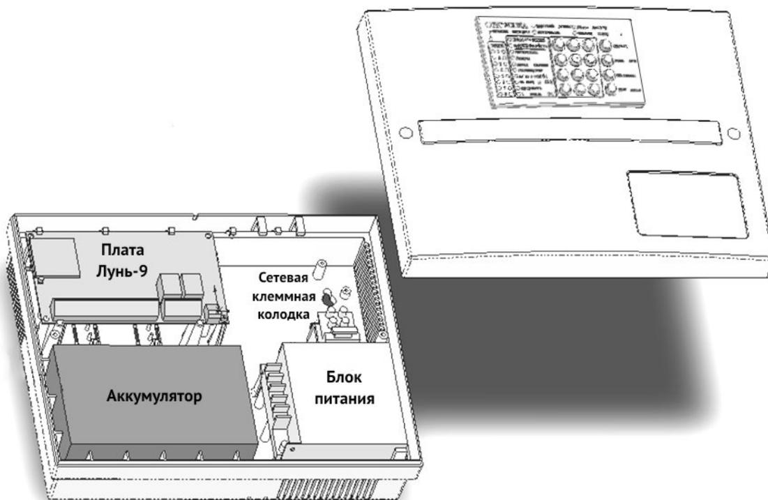
Рисунок 2. Устройство ППКОП
