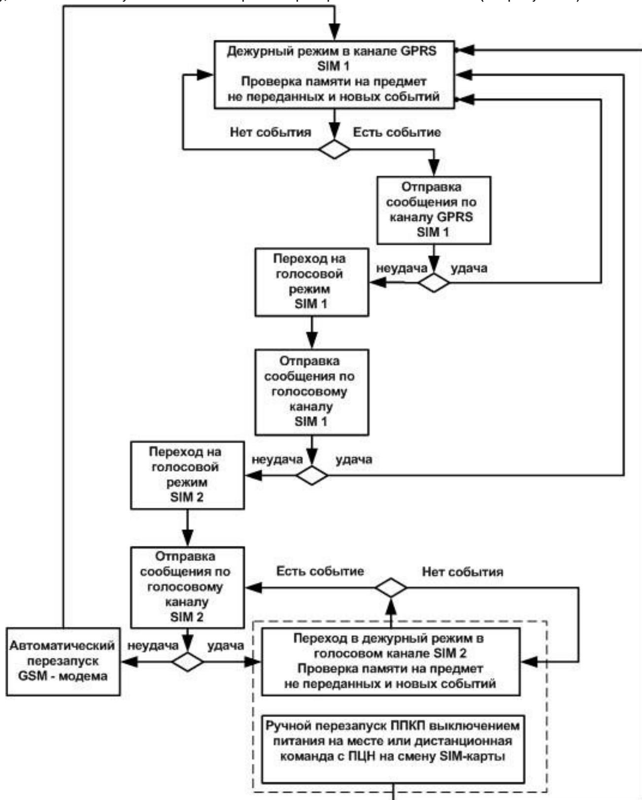
Рисунок 4. Использование GPRS и голосового каналов связи для 2-х SIM-карт
