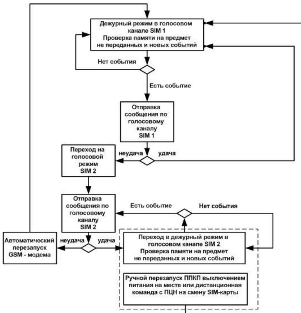
Рисунок 5. Использование голосового канала связи для 2-х SIM-карт
