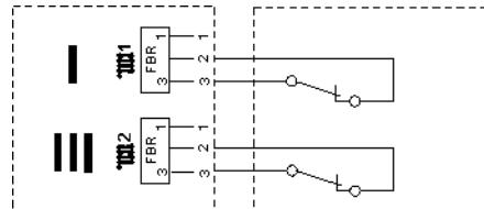
Система отопления может переключаться в режим отопления с помощью телефонного переключателя. Для этой цели служит выводы дистанционного управления FBR (см. схему подключения). Как только появляется сигнал на контактах 2 и 3 соответствующего разъема, относящийся к нему контур нагрева переключается в режим отопления. Также включается подготовка горячей воды. Когда сигнал снимается, регулятор возвращается к работе по заданной программе нагрева.
