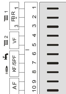
Конт. 1: eBUS или eBUS Антенна DCF
