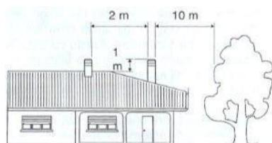
Размеры дымохода могут различаться в зависимости от его модели. Однако в целях обеспечения надлежащего выхода дыма, место выхода воздуха на верху дымохода должно быть в два раза больше, чем сама дымоходная труба, а крышка дымохода не должна мешать протоку воздуха.
