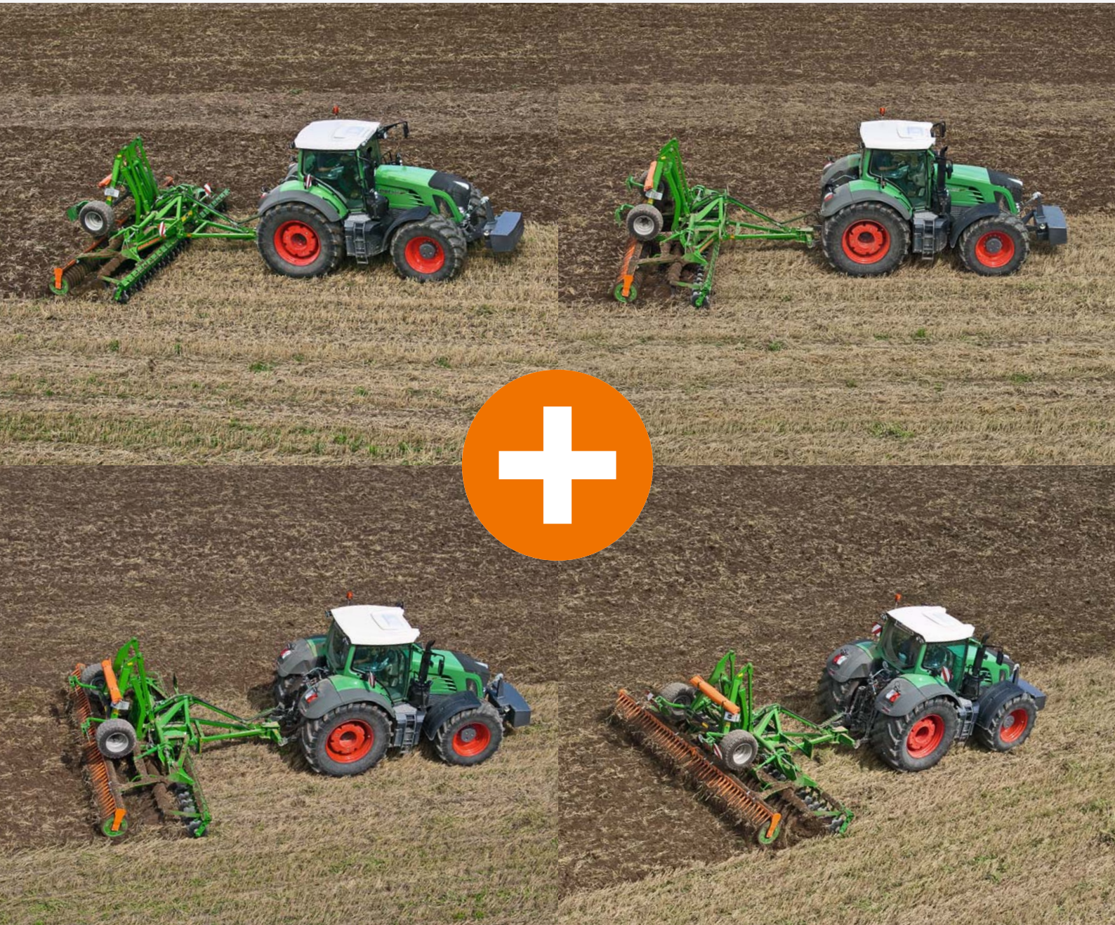
Catros-2TS с поднимающимся шасси
