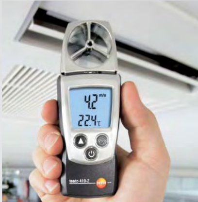
Измерение скорости потока воздуха на вентиляционных решетках с помощью 40 мм крыльчатки
