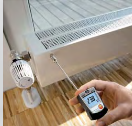
Измерение температуры на поверхности радиатора
