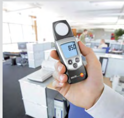
Измерение освещенности на рабочих местах
