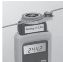
Механическое измерение со счетчиком для нити
