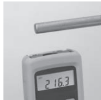
Бесконтактное измерение (оптическое)
