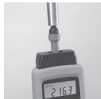
Механическое измерение с наконечником зонда
