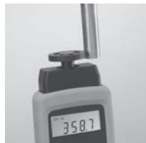
Механическое измерение с вращающимся диском
