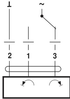
Схема подключения 1 7712 61 и 1 7712 63
