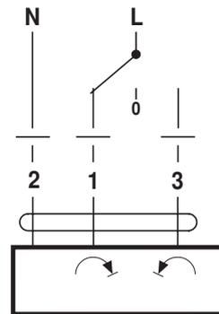
Схема подключения 1 7712 57 и 1 7712 62
