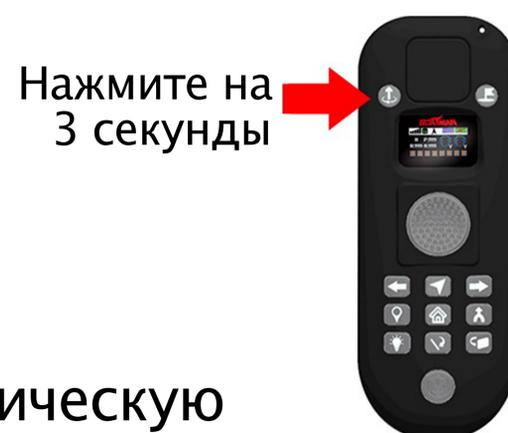
**Возврат одной кнопкой:** нажмите кнопку возврата один раз, значок «Н» домашней точки изменится на красный, лодка вернется в исходную точку автоматически в пределах контрольного расстояния. Контроллер издаст звуковой сигнал, когда лодка достигнет точки возврата. Нажмите джойстик назад, чтобы отменить команду автоматического возврата.
