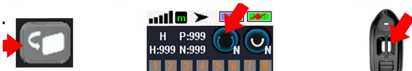
**Откройте задний бункер:** нажмите кнопку «Задний бункер», значок правого бункера на экране покажет открытый, на контроллере прозвучит «ВЕЕР», ночник и задние фонари мигнут четыре раза. Задний бункер открыт успешно
