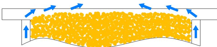
Схема 19. Расположение пеллет относительно ретортной горелки во время работы котла.
