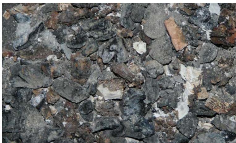
Схема 18. Спекание угля – неправильная регулировка горелки относительно качества топлива.
