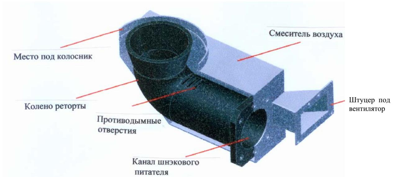
Схема № 14. Идеиная схема ретортной топки при отоплении углем.
