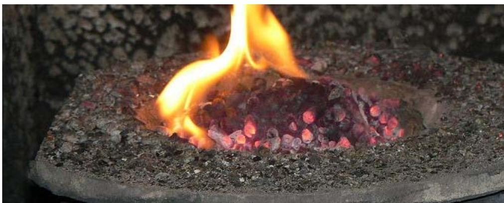
Схема 20. Расположение пеллет относительно ретортной горелки во время работы котла. Ling 15–50kW.
