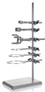
Применяется для крепления лабораторного оборудования, в частности круглодонных и конических колб, стаканов лабораторных, пробирок, бюреток и другой посуды. Необходимый атрибут химической (медицинской) лаборатории. Штатив состоит из вертикальной штанги на прямоугольном основании, трех лапок и трех колец.
