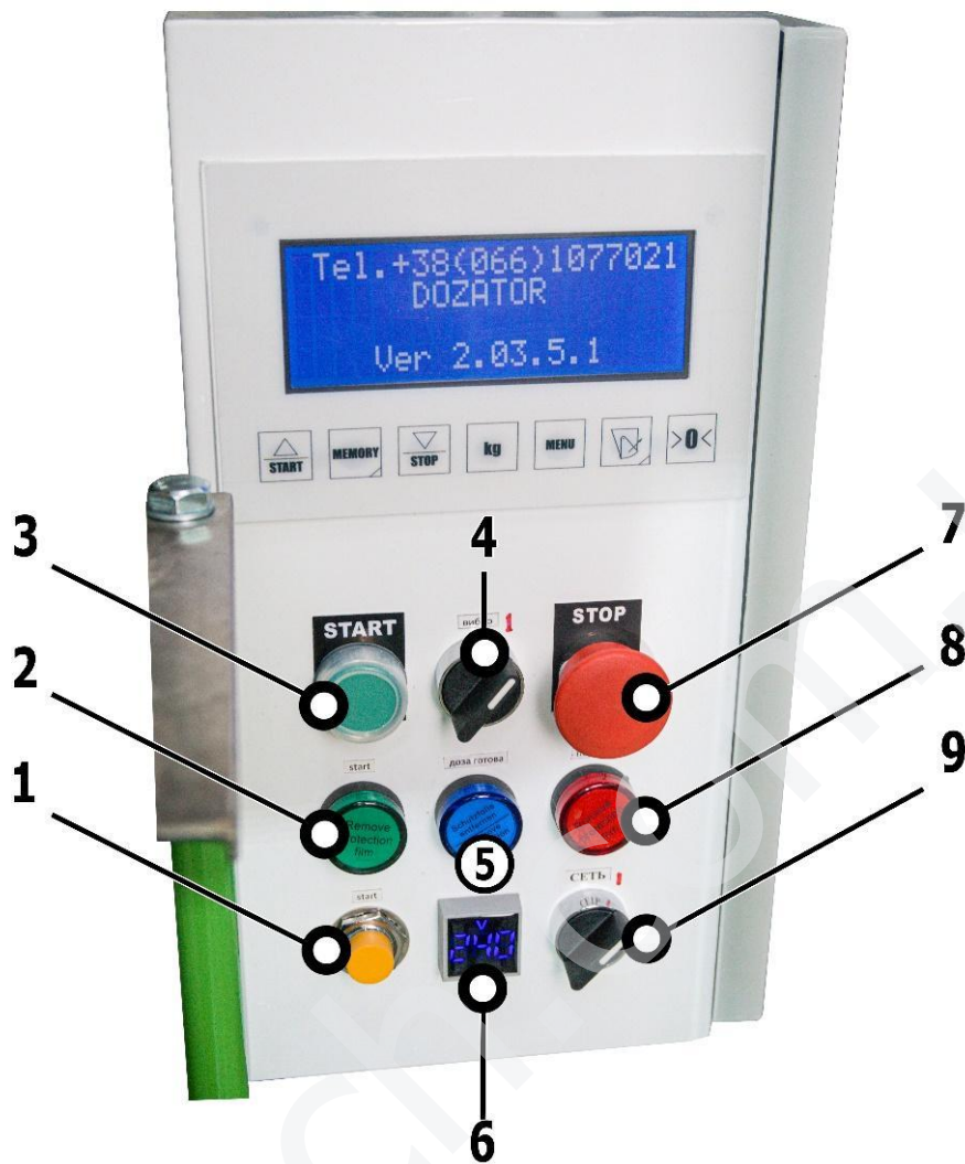
Схема 3 – Расположение кнопок управления на шкафу
