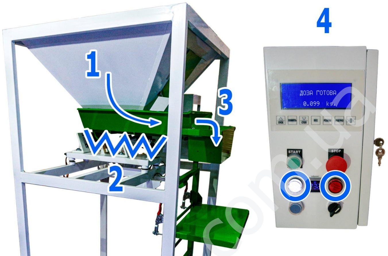
Схема 10 – Порядок работы весового дозатора
