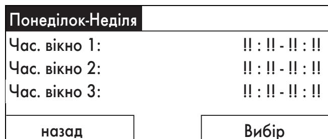
Коли ви викликаєте індикацію блока на дисплей і визначаєте для мінімум одного дня в цьому блоці часове вікно з відхиленням, то на дисплеї значення часу в блоці з відхиленням будуть супроводжуватися символами !!.
