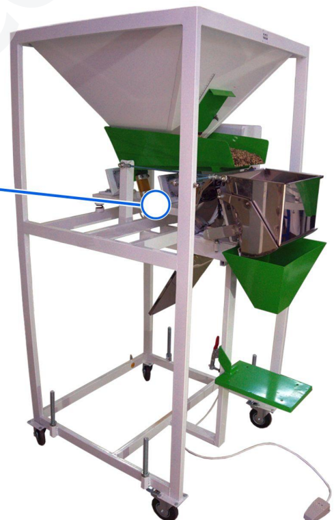
Схема 4 – Снятие транспортировочного болта
