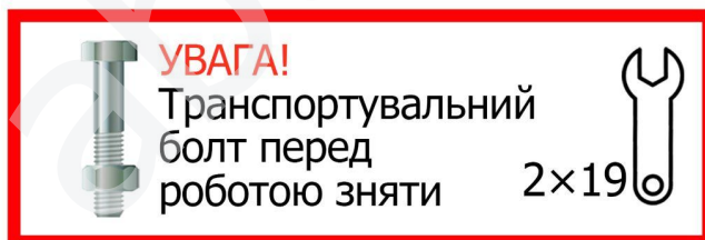
Схема 4 – Снятие транспортировочного болта
