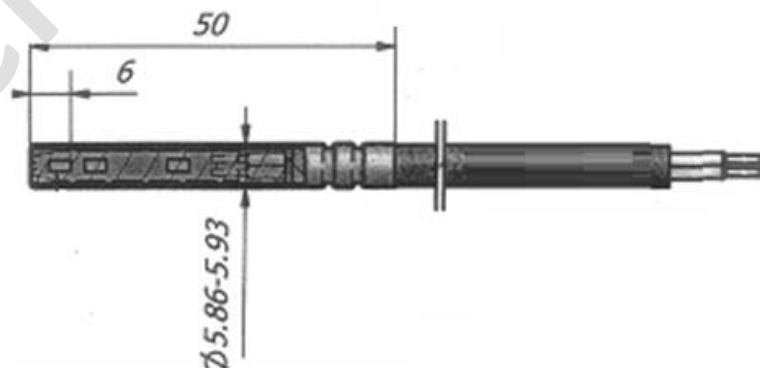
Рис. В3.2. Габаритные размеры датчиков температуры типа PL
