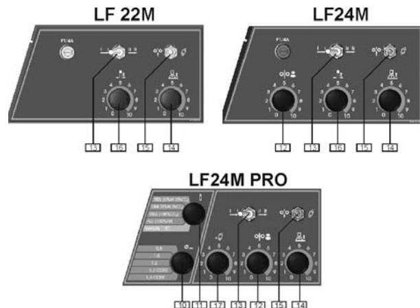
10. **Tråddiameter:** Möjliggör inställning av tråddiameter för den önskade svetsprocessen. Denna funktion används endast i synergiskt läge.
