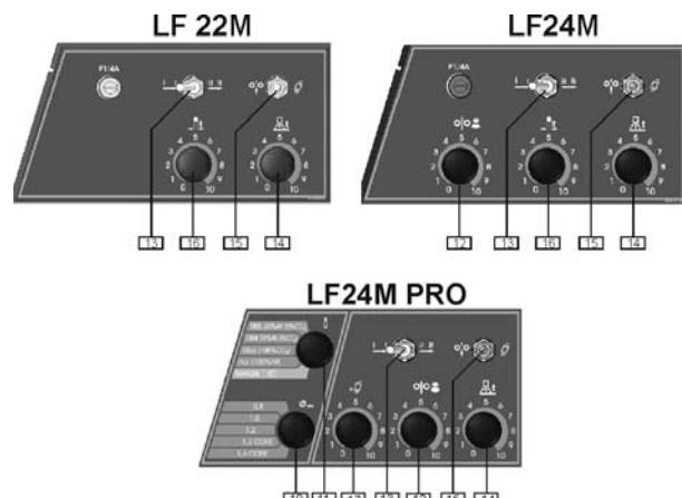
10. **Knop Draad Diameter:** Biedt een voorkeuze voor de gewenste draaddiameter voor het gewenste lasproces. Deze functie werkt alleen in de synergische modus.
