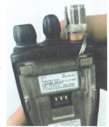
Мал.6 Змонтоване заземлення
