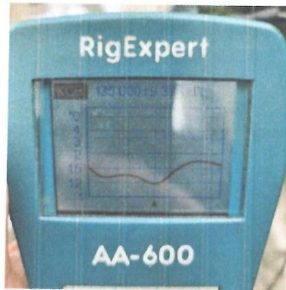
Коефіцієнт стоячої хвилі (КСХ) на частоті 407 МГц:
