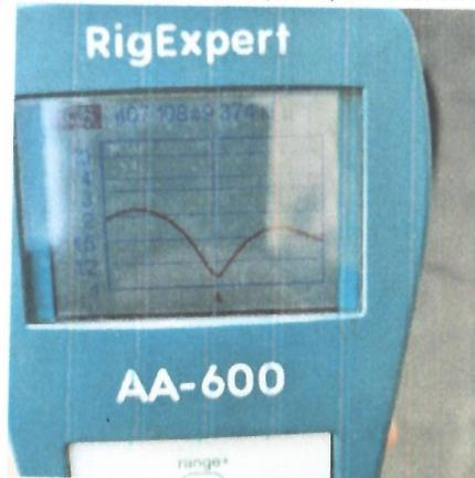
Для верхнього діапазону антена має мінімальний КСХ на частотах 407 МГц, 426 МГц, 439 МГц, 453 МГц, 466 МГц :
