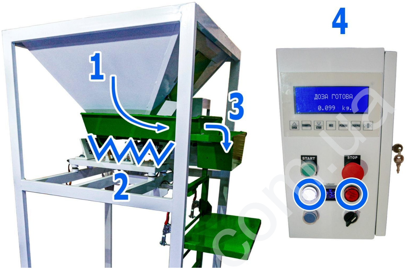
Схема 10 – Порядок роботи вагового дозатора
