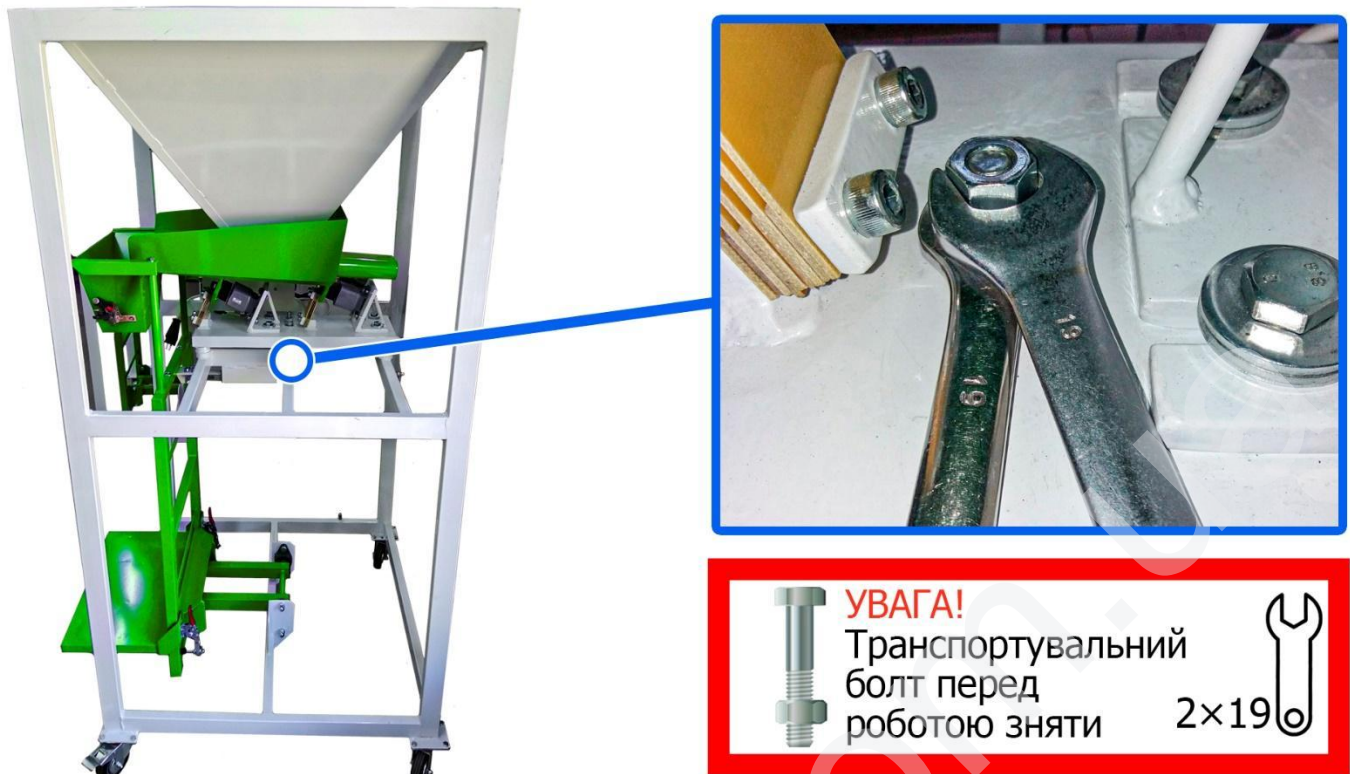
Схема 4 – Зняття транспортувального болта
