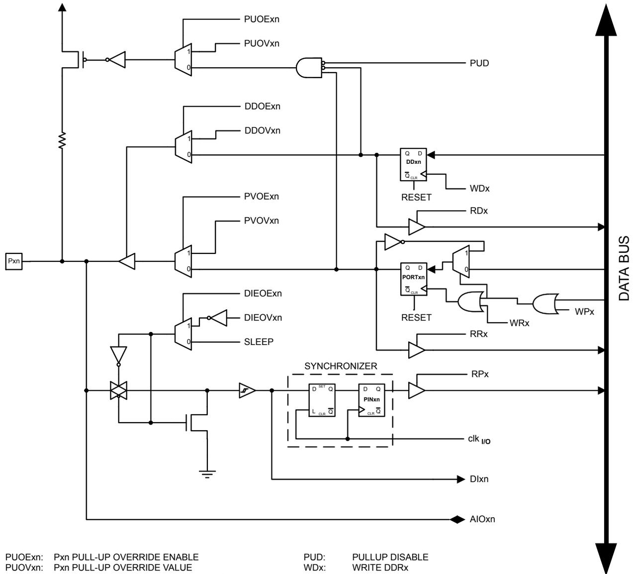
PUOE<sub>xn</sub>: P<sub>xn</sub> PULL-UP OVERRIDE ENABLE
