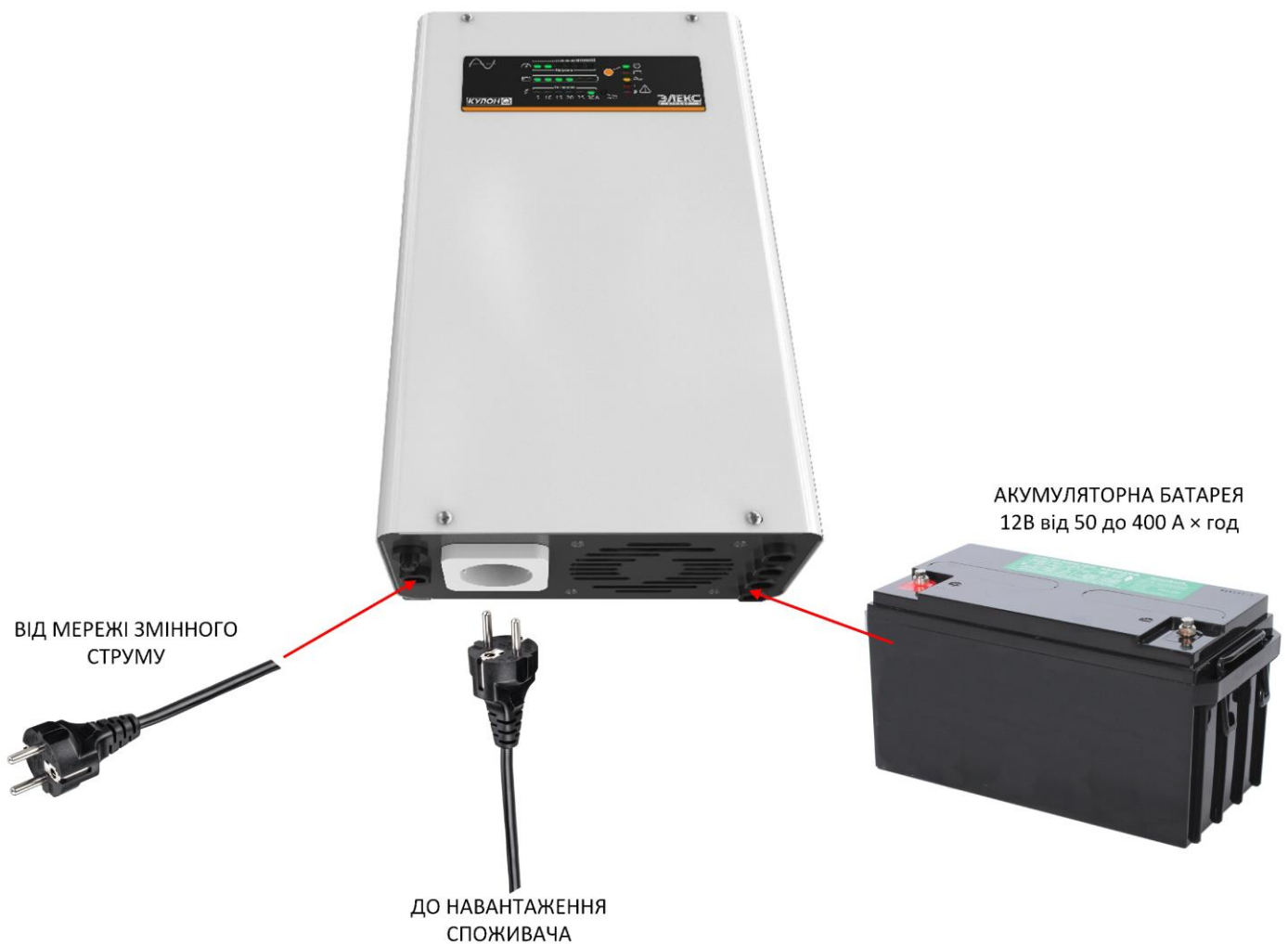
Рисунок 7. Схема підключення ДБЖ до силової мережі
