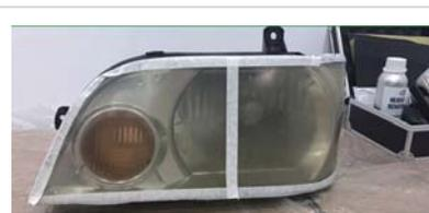
3. Последовательно отшлифуйте абразивами P320-400-600-1000-1500-2000. Если на корпусе
