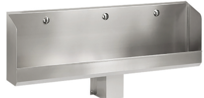
Серія уніталів з великим корпусом, 1 випуском, з кількома інфра-червоними датчиками змивання (SLPN 02E - 1 датчик, SLPN 03E - 2 датчики і т.д.), нержавіюча сталь AISI304, 24V
