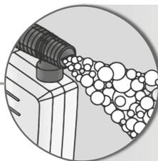
Пенная насадка для моющих средств объемом **350 мл** (входит в базовую комплектацию)
