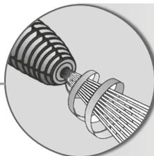
**Регулируемая насадка**, вращая которую можно добиться разной амплитуды потока: от очень узкой струи до широкой веерной.
